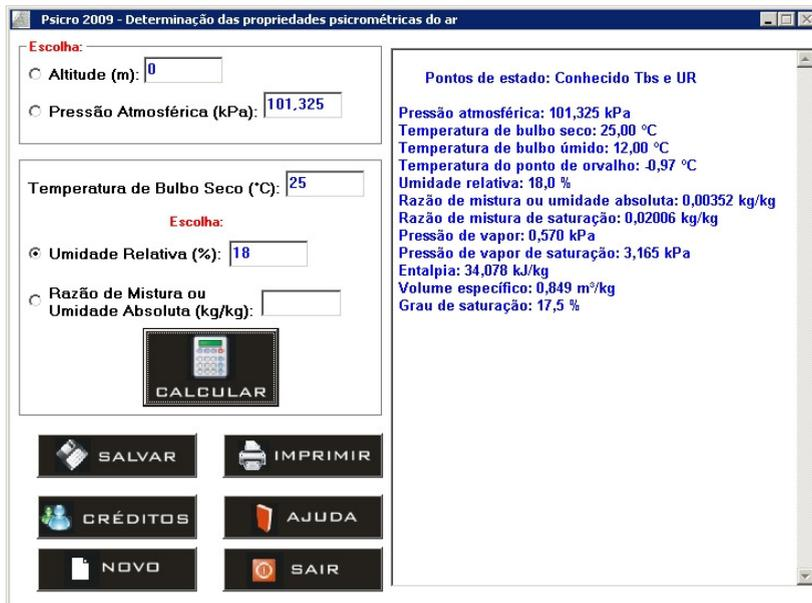
Figura 3 Janela principal do programa com exemplo de determinação das propriedades psicrométricas
