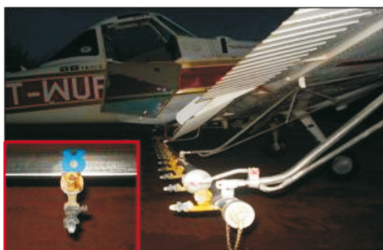
Figura 2. Aeronave Cessna A188B Ag-Truck equipada com bicos da marca Stol em sua barra de pulverização.
