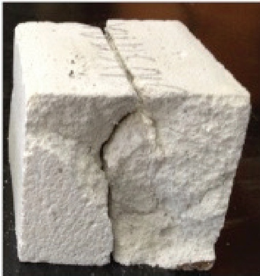
Figura 4. Formato típico das fissuras
