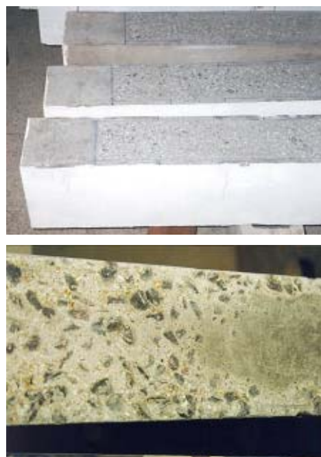
Figura 3: Detalhe dos agregados expostos após a preparação da superfície de concreto – à esquerda Ferrari (2002) e à direita Beber (1999)
