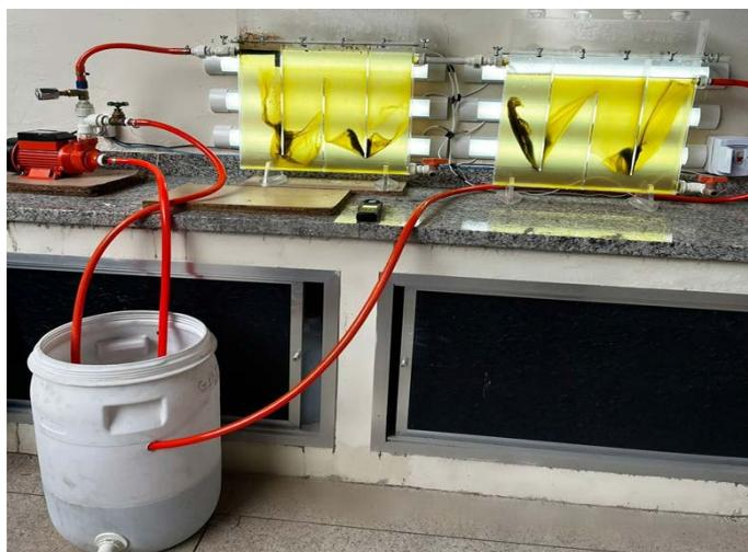
**Figura 1.** Layout do experimento: fotobiorreatores verticais de placa plana e seus componentes hidráulicos
