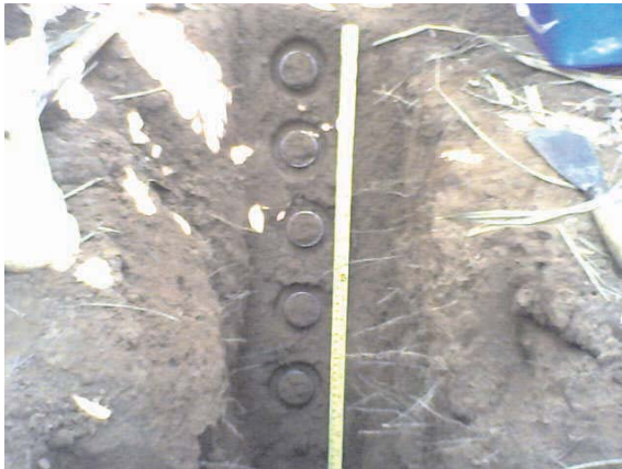
Figura 4 Coleta de amostras deformadas ao longo do perfil do solo
