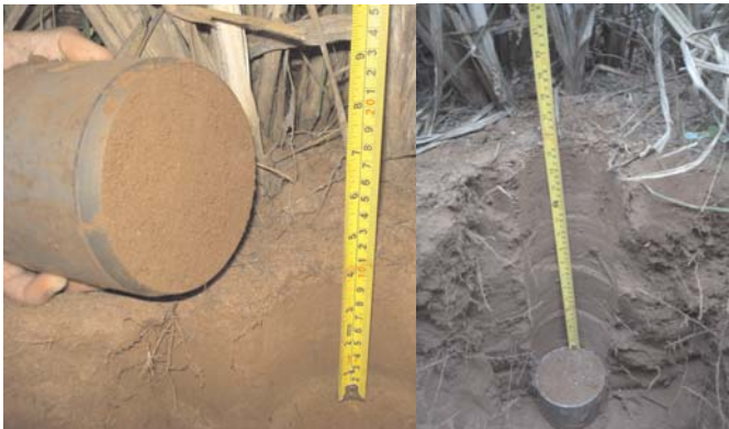
Figura 5 Amostrador cilíndrico para quantificação do Sistema Radicular, coletando amostras da profundidade de 0,0-0,10 m, até a camada de 0,5 m do perfil do solo
