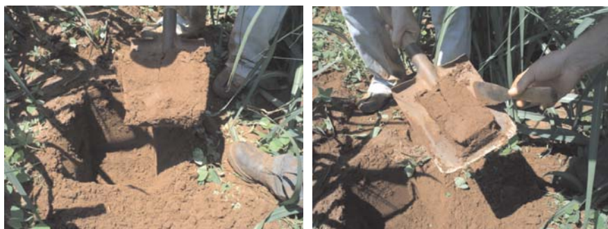
Figura 1 Coleta de amostras de solo nas profundidades de 0,0 - 0,20 m e 0,20 - 0,40 m
