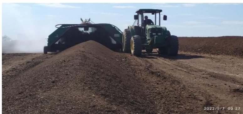
Figura 3. Processo final de produção do adubo organomineral
