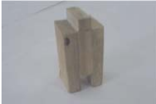
Figura 10. Corpo-de-prova utilizado no ensaio de cisalhamento da superfície colada.
