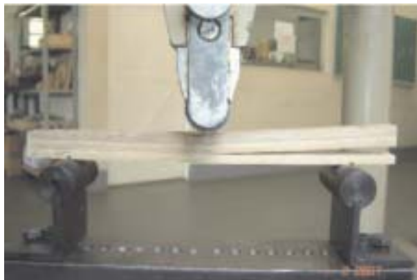
Figura 5. Rompimento na linha de cola.
