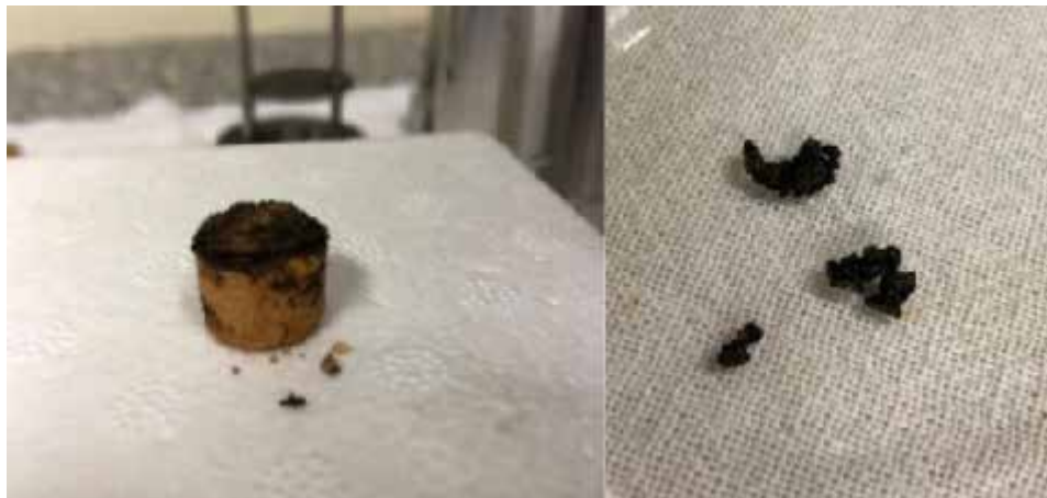
Figura 1. Ao lado esquerdo lodo de ES de menor granulometria e ao lado direito lodo de ES de maior granulometria após serem submetidos ao calorímetro.
