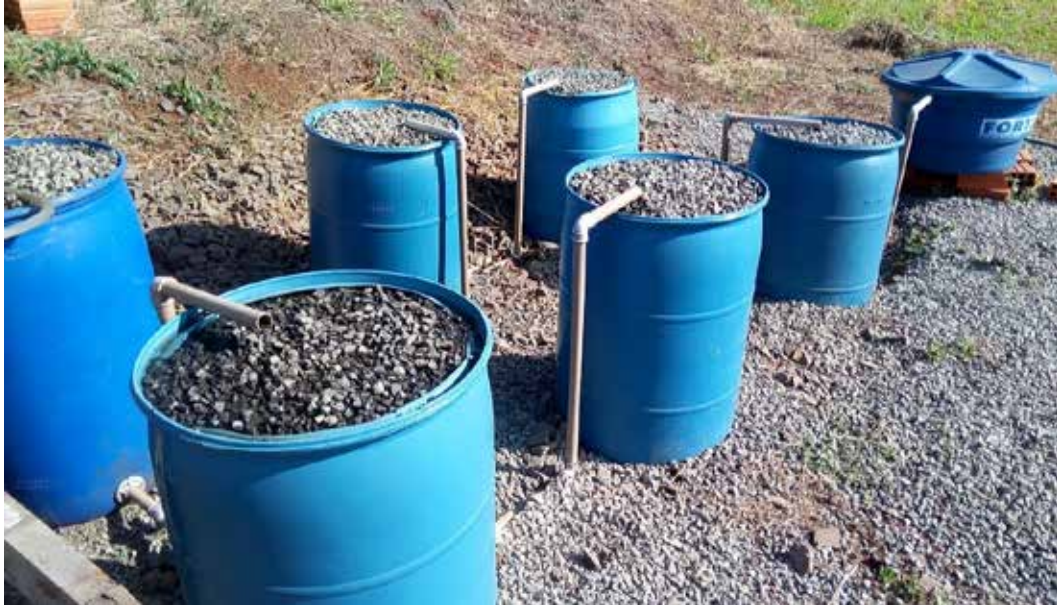
Figura 1. Estação de tratamento de efluentes de esgoto doméstico instalada na área experimental do Departamento de Engenharia Rural Campus da FCA-Unesp, Botucatu
