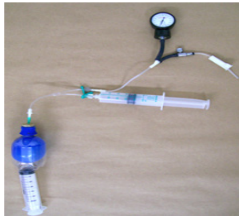
Figura 2 Foto com o modelo representativo PVMCAA (F – Seringa de 60 mL; G – Válvula e H – Manômetro analógico de pressão)
