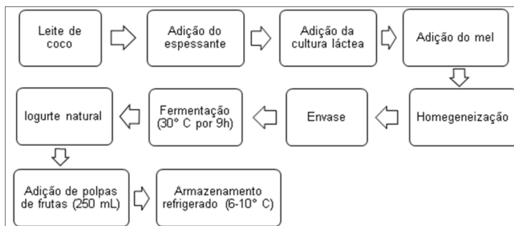
Figura 2. Fluxograma da elaboração do leite fermentado à base de leite de coco com adição de polpa de frutas.
