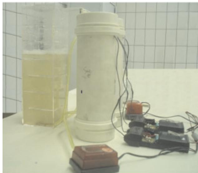
Figura 3. Gerador de ozônio utilizado para o experimento
